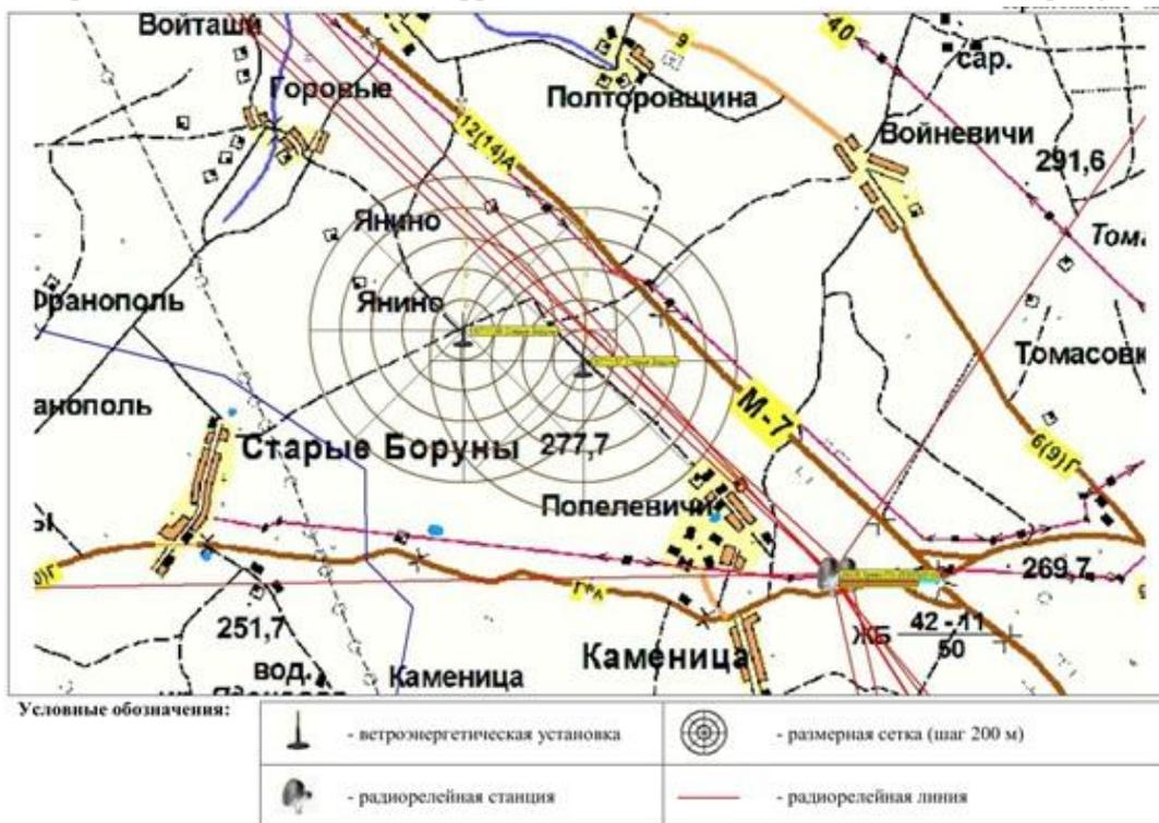
Рисунок 4.4. – Результаты расчётов обеспечения электромагнитной совместимости с радиоэлектронными средствами фиксированной службы в районе размещения проектируемой ВЭУ
